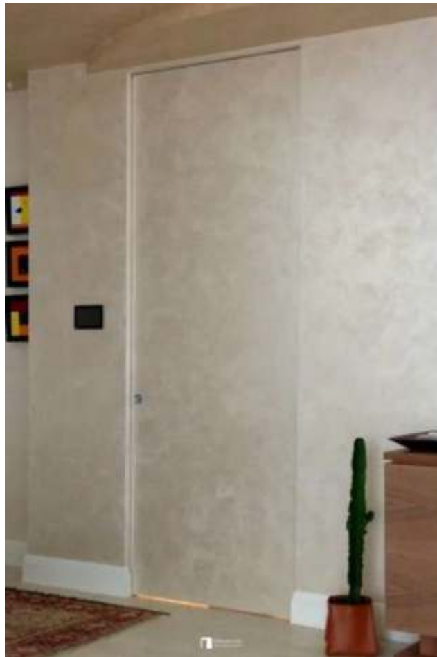
Scomparsa Totale — Binario superiore portata 80Kg, corsa silenziosa, assenza totale di stipiti a vista.
